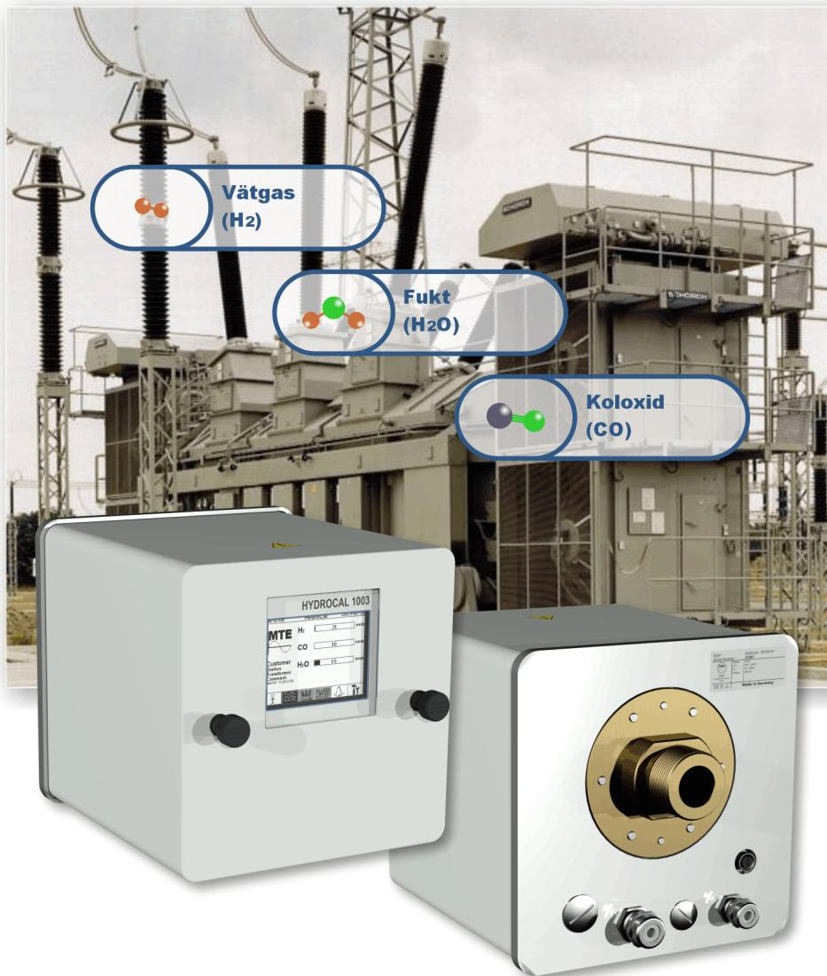
Mätning och analys av gaser upplösta i transformatoroljan, är det erkänt vanligaste och kanske säkraste sättet att tidigt indikera begynnande skador på transformatorn.
